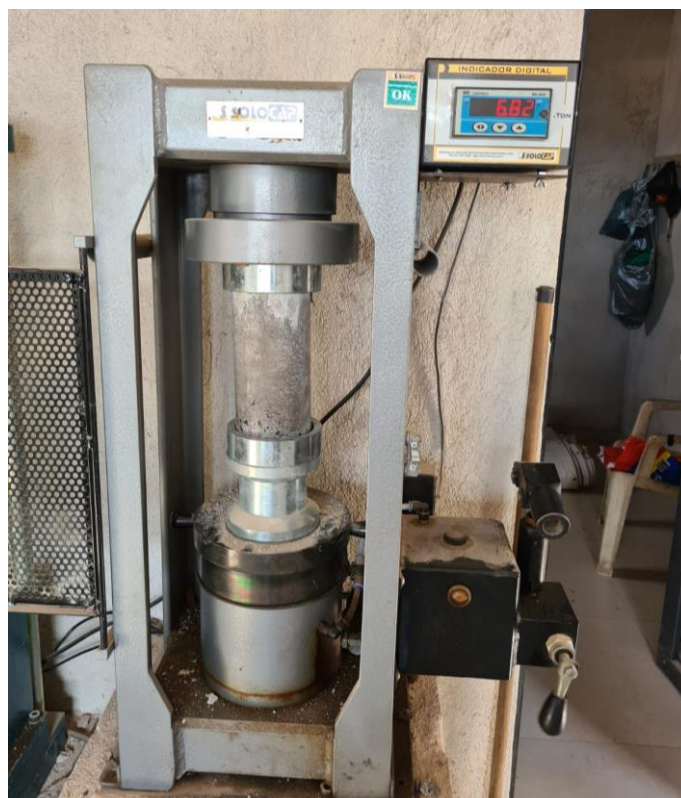
Figura 3 – Rompimento do corpo de prova em prensa manual.
