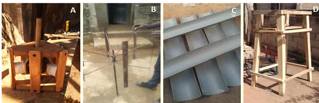
Figura 3: Partes do aerogerador: (A) aerogerador; (B) rotor; (C) pás com tubos policloreto de vinila (PVC); (D) torre de sustentação. Fonte: Autores, 2020.
