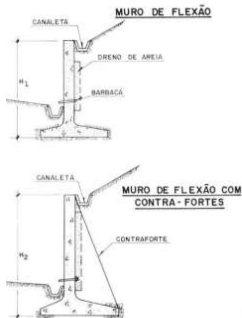
FIGURA 14 – Muro de Flexão
