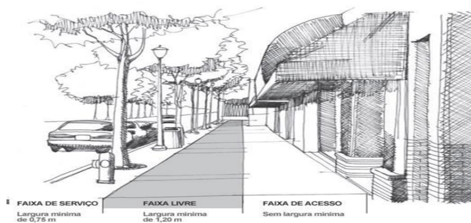
FIGURA 4 - Esboço de uma calçada em total acordo com a ABNT. NBR 9.050/2015
