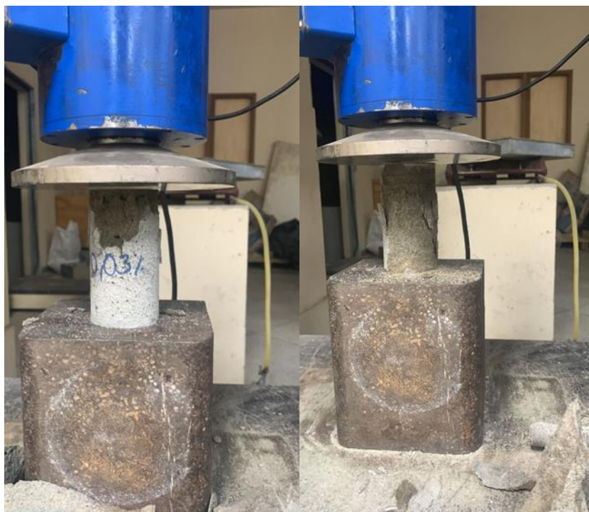
Figura 1- Ensaio laboratoriais de compressão axial dos corpos de prova.
