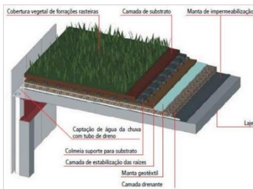
Figura 1: Estrutura do telhado verde
