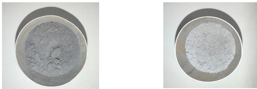
Figura 3 - (a) Sílica como recebida (b) Após tratamento térmico a 450 °C.
