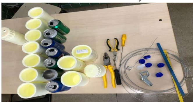
Figura 1. Material utilizado na construção do calorímetro.
