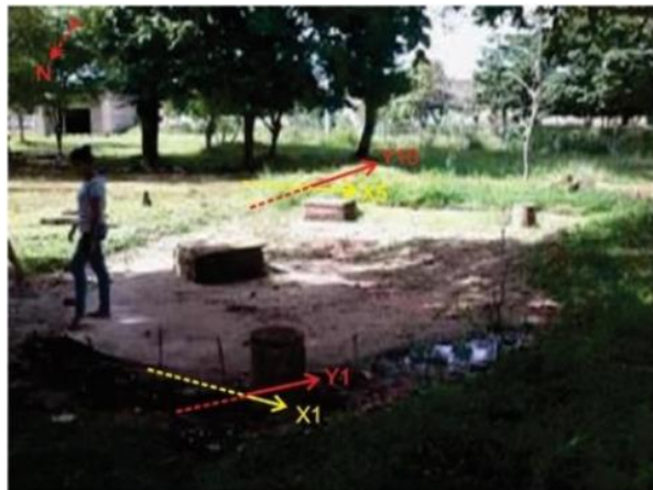
Figura 3 – Fossa Séptica da UFOPA.O levantamento da fossa séptica teve o como objetivo identificar se a mesma estaria liberando para o solo plumas de contaminação.
