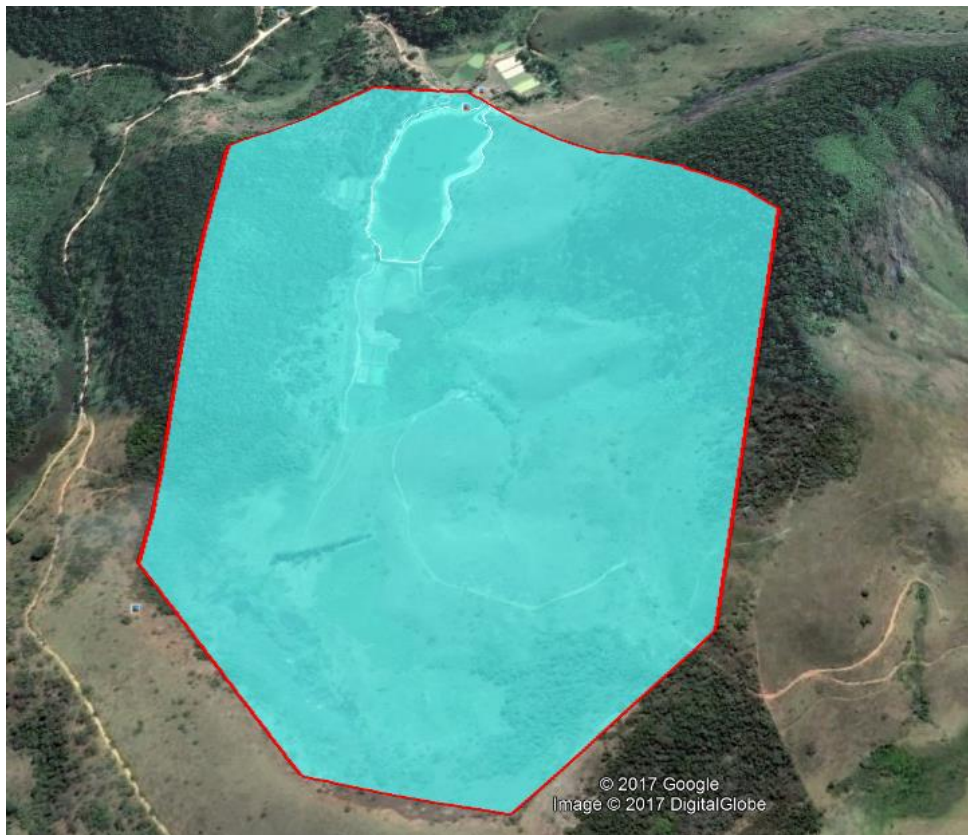
FIGURA 04 - Limite da área de contribuição da barragem
