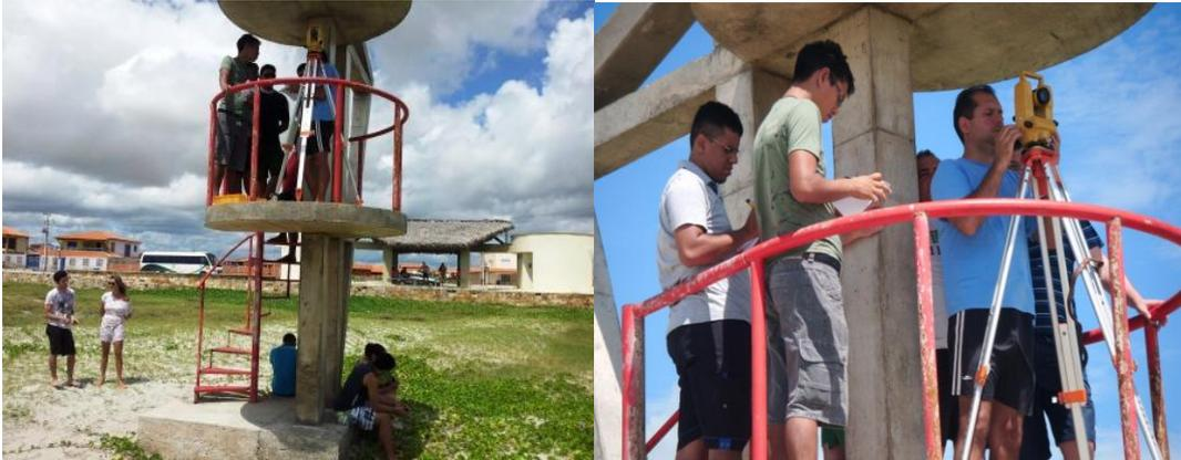
As medições da distância da guarita até a beira mar e do ângulo formado com o centro da base do teodolito e a estaca foram utilizadas para o cálculo da altura do teodolito em relação ao nível do mar ( $h = x + 3,94$  m) de acordo com a esquematização apresentada na Figura 4:
